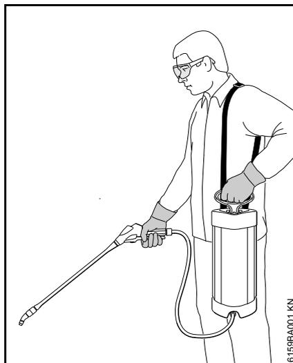
Colocar o equipamento com o cinto no ombro esquerdo. Não cruzar o cinto nas costas, para que a máquina possa ser retirada ligeiramente das costas, em caso de necessidade.
