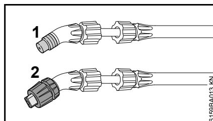
Conforme a necessidade, pode ser acoplado um bico cônico (1) ou um bico chato (2).
